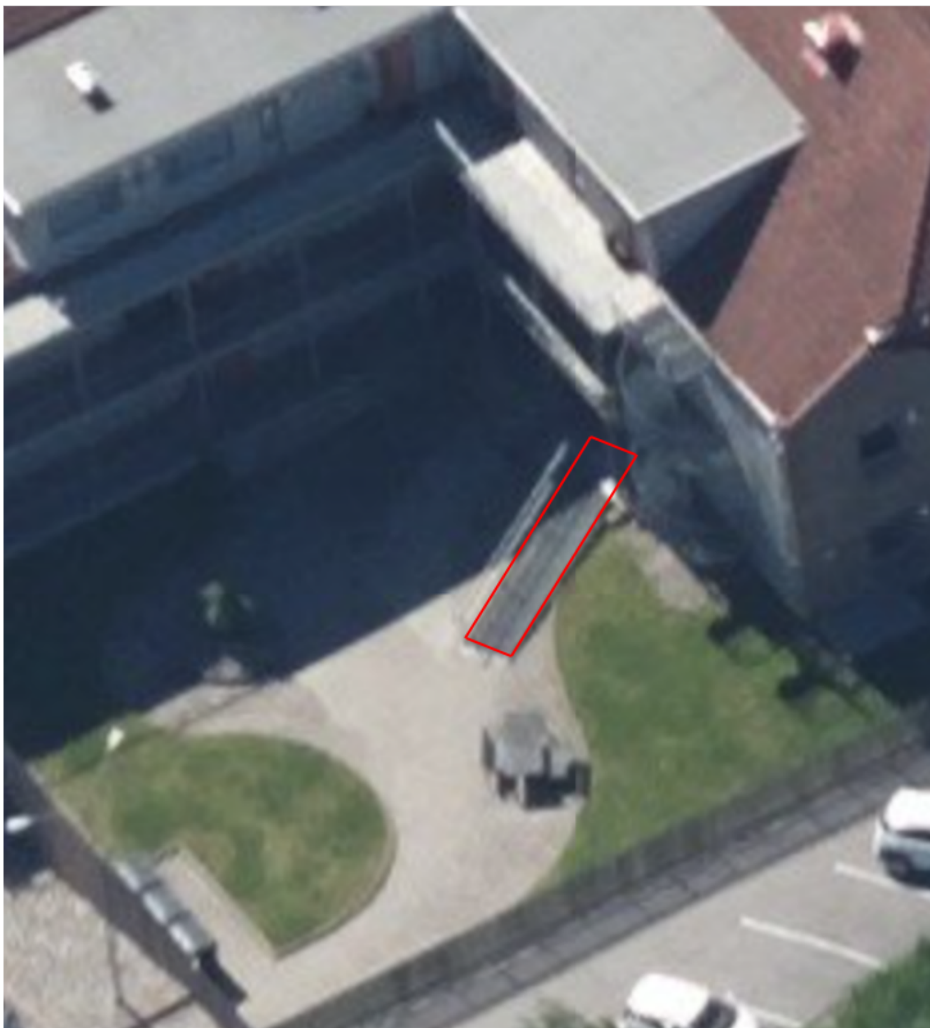
Figur 43. Eksempel på rullestolrampe til bygning registrert som BygningBru
